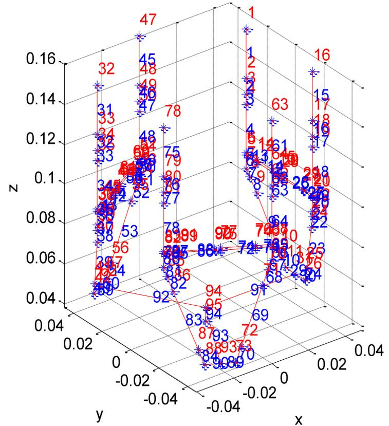
Il est possible de modéliser et calculer un système mécanique complexe de manière très fiable déjà par des modèles à éléments finis relativement simples: ici un hexapode pour un positionnement de précision en 6 axes modélisé entièrement par des éléments de type poutre-3D.
