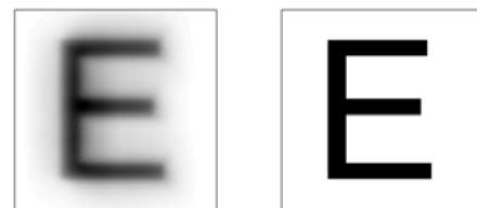
Image perçue avant et après correction par optique adaptative
