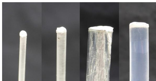
Abb. 6.30 : Beispiel von Bedeckung der Probe mit Schichten von Bariumsulfat und Aluminium
