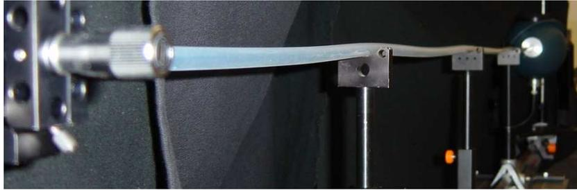
**Abb. 6.21** : Unterstützung Für dickere Fasern mit Mantel
