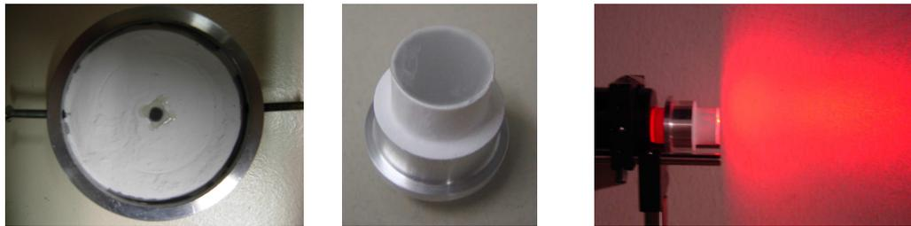
Abb. 6.28 : Abdeckung und kleine Röhren mit Streufolie
