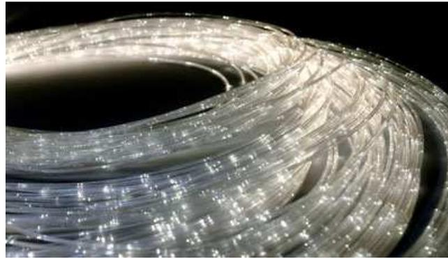
**Abb. 5.9 :** Sternenhimmelleffekt durch das Einschneiden der Faser [21]
