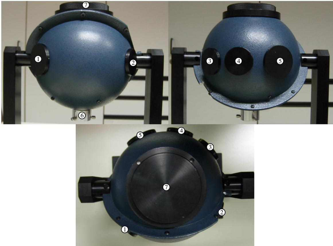
Abb. 6.15 : Verschiedene Ansicht der Ulbrichtkugel
