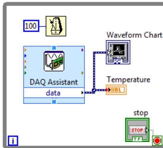
Réaliser l'acquisition d'une montée/descente de la température en saisissant le capteur dans la main puis en le relâchant. Le temps d'échantillonnage sera de l'ordre de 0,5 ou 1 seconde.
