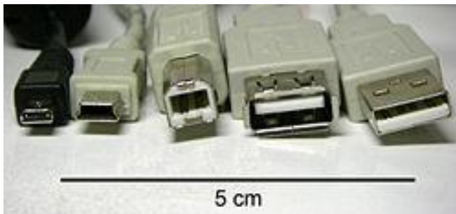
Types de connecteurs USB, de gauche à droite: micro USB, mini AB, type B, type A femelle et type A male
