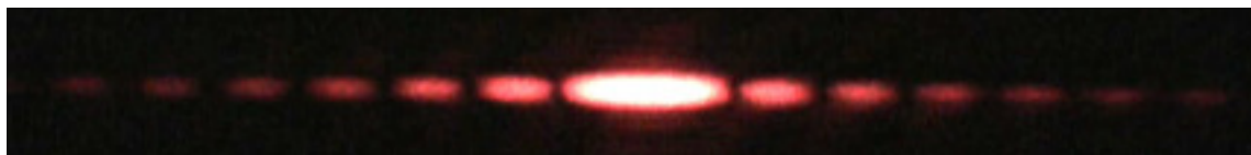
Figure 13-1: Motif de diffraction causé par une fente sur un écran à une certaine distance. Si la fente devient plus étroite ( D plus petit), la figure de diffraction s'élargit: le pic central devient plus large. On remarque bien le maximum central et ensuite les maxima secondaires, intercalés par les minima espacés régulièrement.
