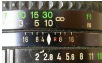
En passant au diaphragme 16, les distances peuvent être divisées par 2 et, avec une mise au point sur 5 m, la netteté obtenue s'étendra de 2,5 m jusqu'à l'infini.
