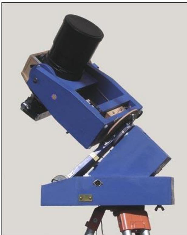
Figure 7.9 Petit télescope photographique de Maksutov (diamètre 10 cm, focale 1 m) en monture équatoriale à fourche. Le bâti est fixé sur un robuste pied de géodésie. L'entraînement est fait par secteur lisse et moteur synchrone (visibles en bas à gauche). Remarquez l'inclinaison de l'axe polaire, et le porte-à-faux de la fourche. Le poids de l'ensemble fourche-télescope est porté par les paliers de l'axe polaire, noyés dans la poutre dépassant du bâti.
