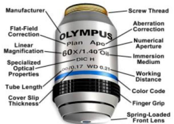
L'**ouverture numérique** est définie comme le produit de l'indice de réfraction de l'échantillon par la moitié de l'angle d'ouverture de la lentille frontale. La résolution axiale et latérale de l'objectif est proportionnelle à cette valeur.
