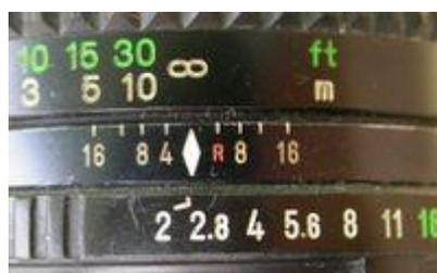
On lit 5 m à 16, 10 m à 8 et, en prolongeant la série, on déduit 20 m à 4 ou 40 m à 2, ouverture maximale de cet objectif.
