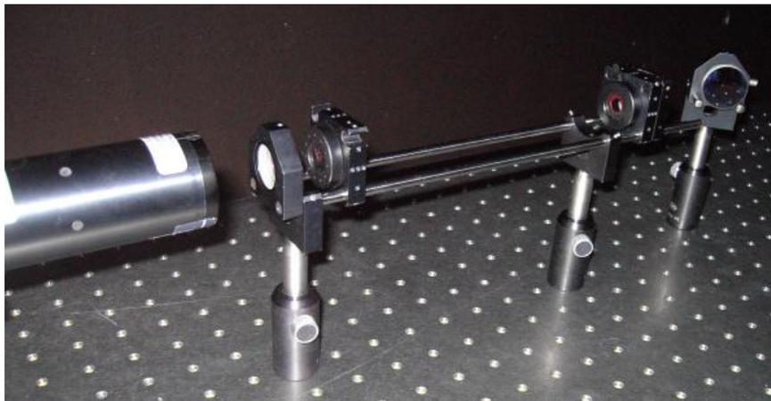
5. Poser en suite les autres éléments optiques en suivant le sens de la lumière. Attention au sens du *beam splitter*.
