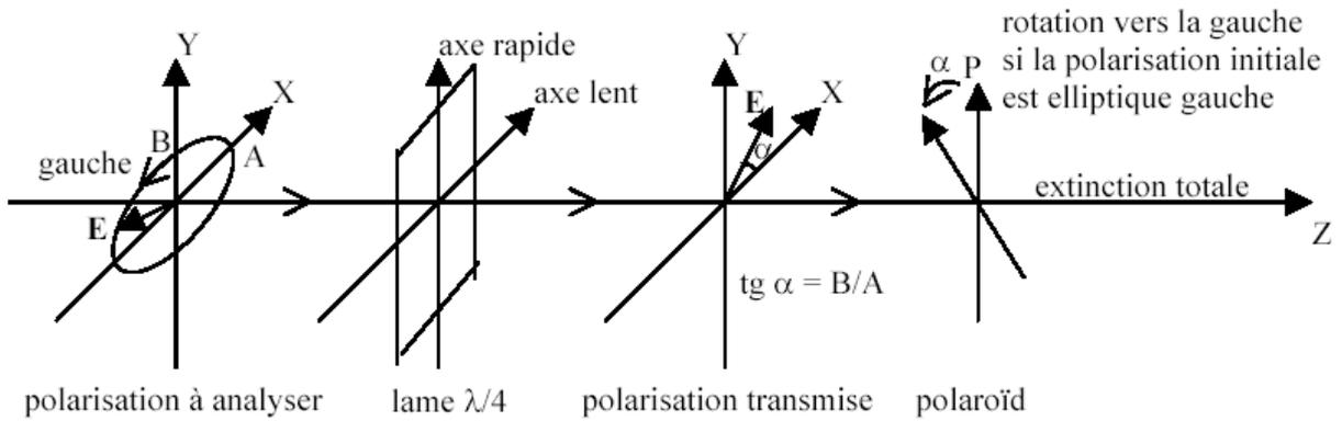
Hypothèse : Polarisation incidente elliptique gauche, de degré d'ellipticité B/A ( $B < A$ ), X = grand axe, Y = petit axe :
