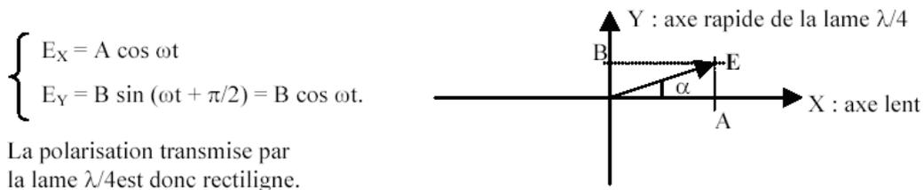
En d'autres mots, une onde entrante elliptique dont les axes de l'ellipse coïncident avec les axes de la lame donne une onde sortante rectiligne.
