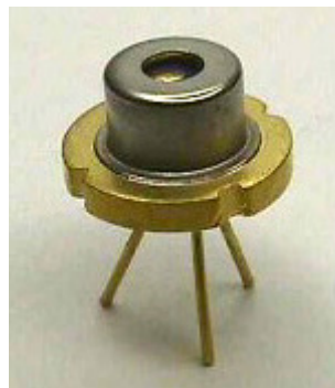
Un laser à semi-conducteurs. Sa monture a 9 mm de diamètre. Le laser comme tel se trouve dans le trou, au centre.
