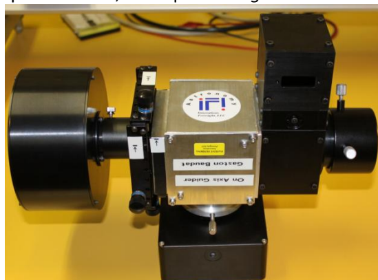
Figure 66 : vues de l'ensemble tip-tilt, beamsplitter, et autoguideur
