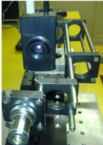
Figure 64 : Bras instable reliant caméra-objectif
