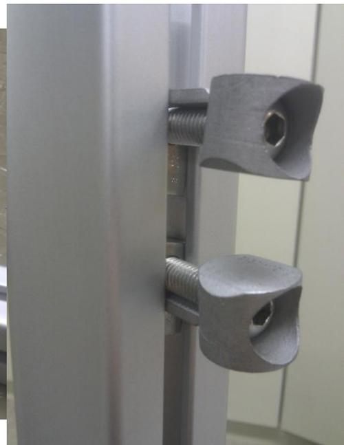
Figure 52 - Fixation du haut de la base
