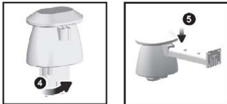
4. Insérer le capteur dans le boîtier, tourner et cliquer vers la droite pour bien fermer.
