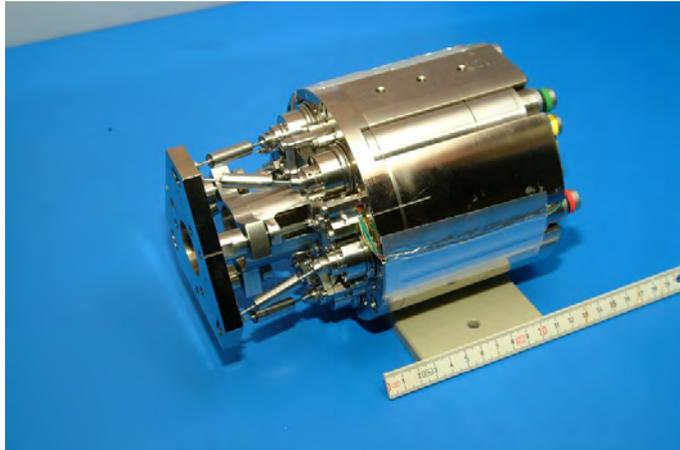
FIGURE 2.1 – Hexapode réalisé par le CSEM.
