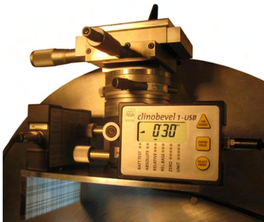
L'inclinomètre fonctionne grâce à un système capacitif à pendule. Sa précision est de 0.02 mm/m qui correspond à 20  $\mu$ rad soit 5 arcsec. Aucun système de mesure de l'inclinaison du plan n'a été intégré dans la structure, cependant la surface de la plaque simulant le miroir a été conçue suffisamment grande afin de pouvoir y poser un inclinomètre dans chaque axe.
