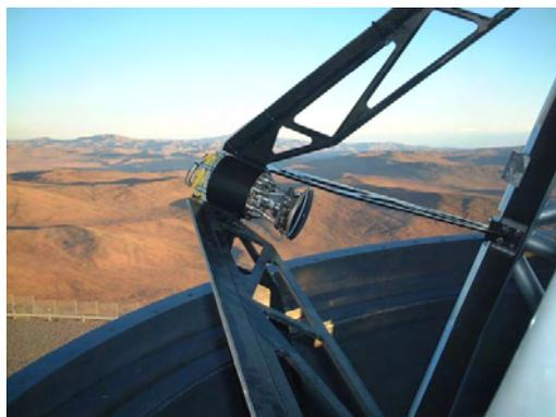
FIGURE 1.1 – Mécanisme de type hexapode permettant le déplacement du miroir secondaire sur le télescope VLTi dans l'observatoire de l'ESO à Paranal au Chili.
