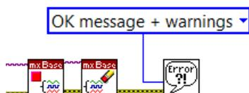
Dans le cas où l'arrêt aurait été causé par une erreur, et non pas un arrêt intentionnel, un message d'erreur apparaît à l'utilisateur.
