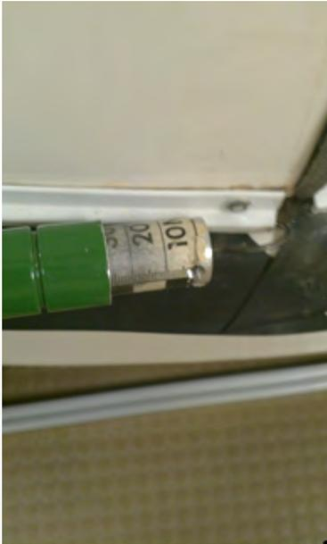
FIGURE 2 – Mesure de la force tangentielle au dynamomètre.
