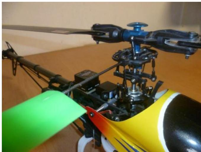
Figure 5 : mécanique d'un rotor à pas variable source : <http://forum.heli4.com>
