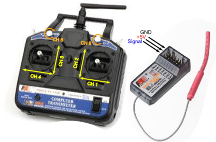
Figure 7 - Correspondance entre les pistes de la télécommande et du récepteur
