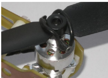
Figure 18 - Fixation d'une hélice à l'aide d'un joint torique élastique
