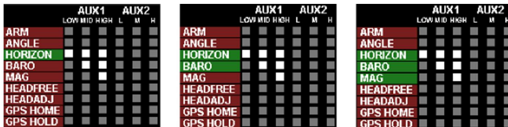
Figure 27 - Modes de vol enclenchés en fonction de la position du potentiomètre
